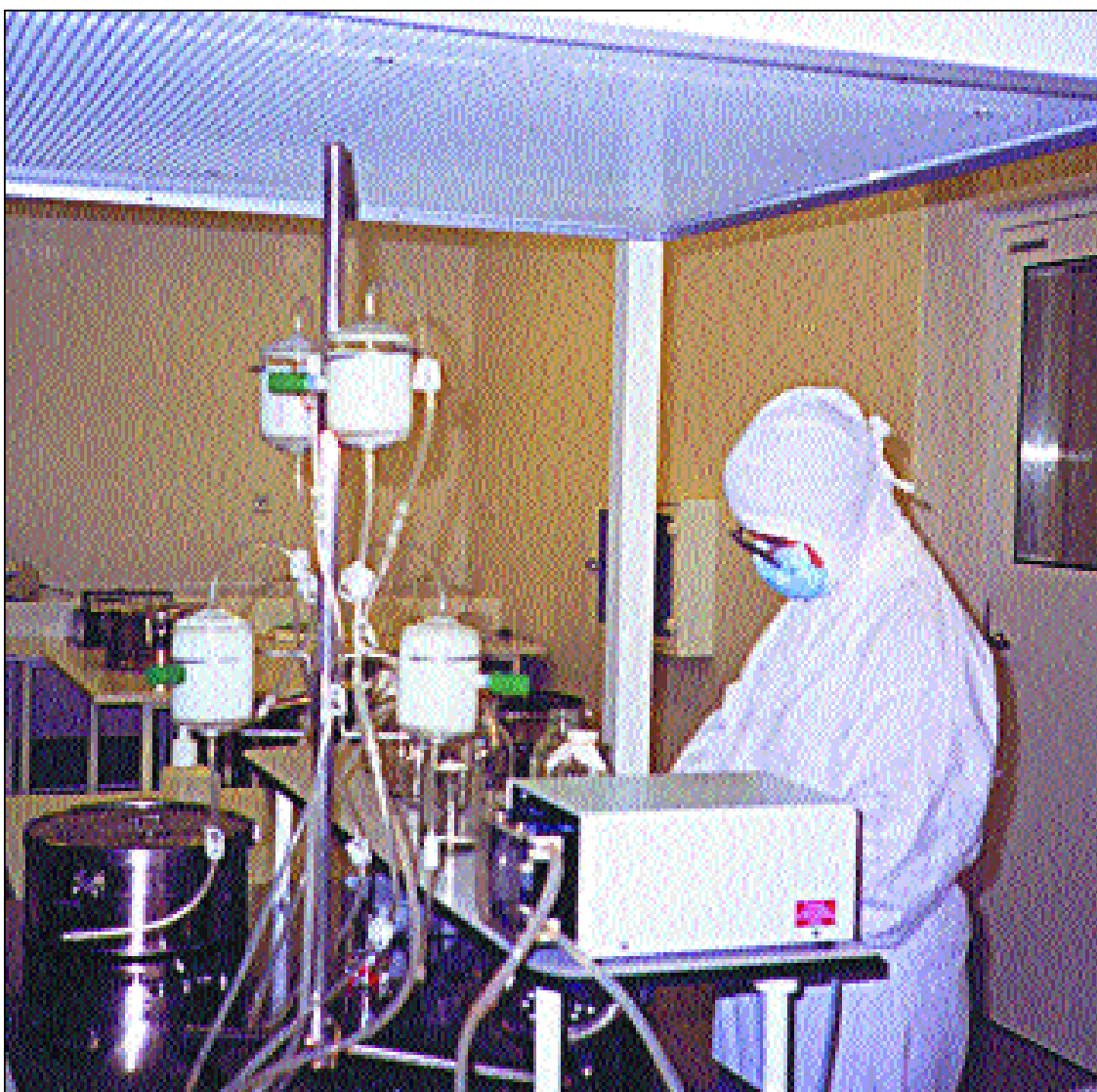
Завершающая производственная стадия — заполнение колонок сорбентом.
