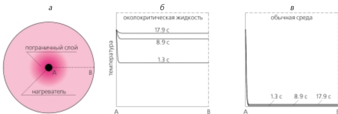
Рис.3. Упрощенная схема эксперимента по исследованию переноса тепла (а). Рост температуры по радиусу вдоль линии А—В в околокритической жидкости происходит очень быстро (б), намного быстрее, чем в обычной среде (в).
