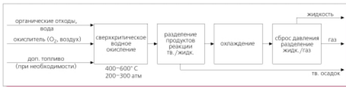
Рис.8. Схема процесса сверхкритического водного окисления.
