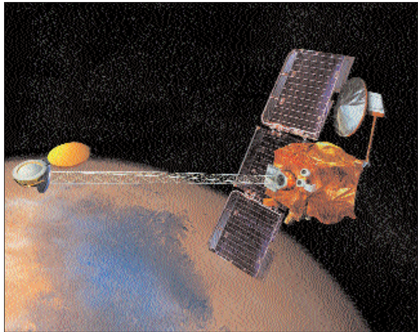
Рис. 1. Космический аппарат НАСА «Mars Odyssey» с российским нейтронным спектрометром HEND на борту.
