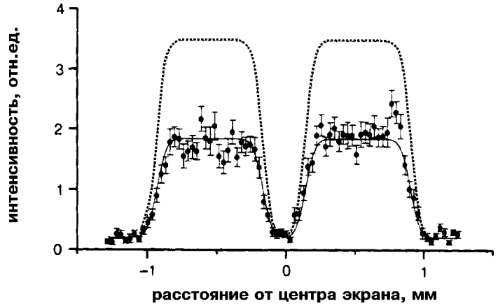
Рис.4. Исчезновение интерференции при включении микроволнового поля, записывающего информацию о траектории атома в его электронной структуре.
