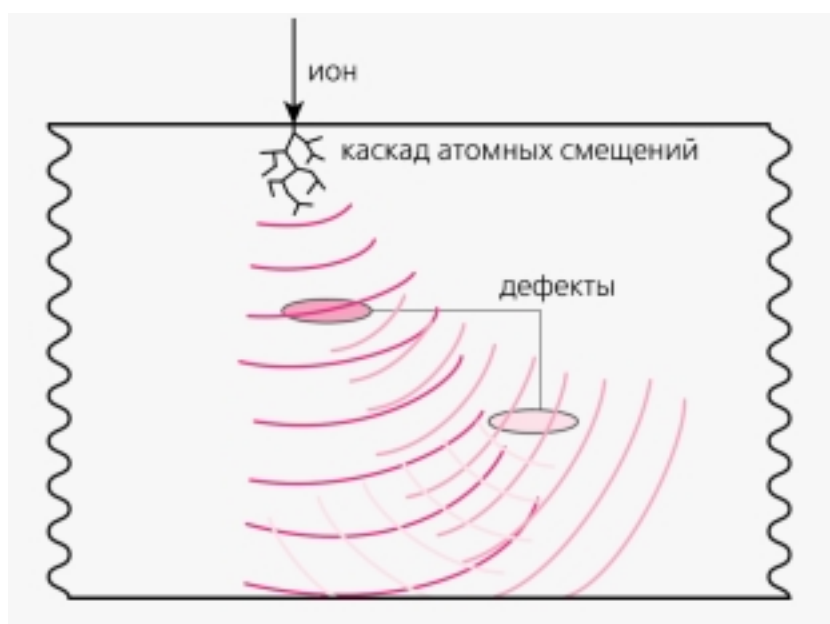
Рис.2. Цепной процесс генерации акустических волн. Для наглядности изображены только два дефекта. Масштаб не выдержан.
