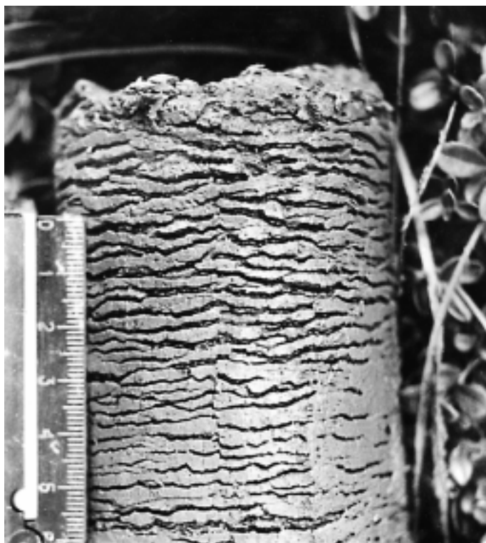
Мелкие ледяные шпильки в вечномерзлых породах (керна, полученный при бурении скважины) в долине нижнего течения р.Виллюй (Центральная Якутия).
