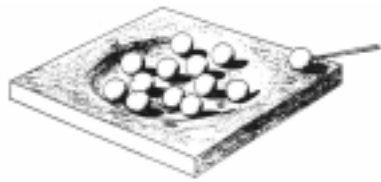
Рис.3. Механическая модель Н.Бора, демонстрирующая, как ускоренная частица взаимодействует с нуклонами ядра, вызывая его нагрев.
